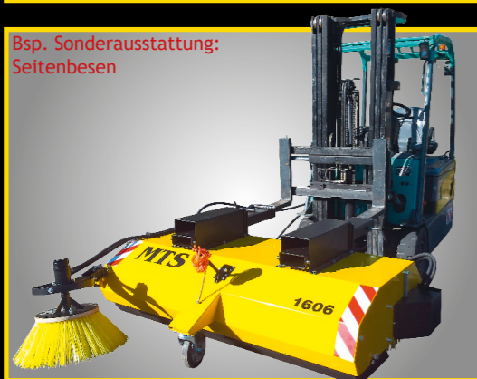
Bsp. Sonderausstattung: Frontladeraufnahme, Seitenbesen und Wassersprüh
