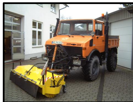
Bsp. Sonderausstattung: Hebevorrichtung und Geräteplatte für Unimog, Spritz Tuch und Warnfahne
