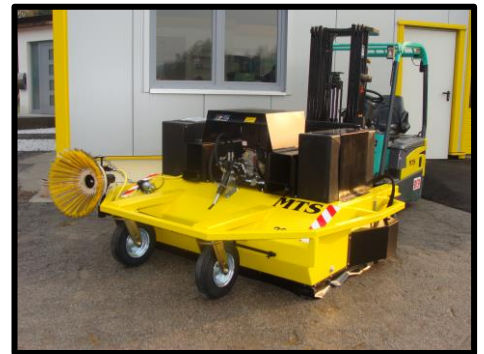
Bsp. Sonderausstattung: 2002 in verstärkter Ausführung inkl. Rammerschutz und extra großen Rädern, Seitenbesen, Dieselaggregat und Wassersprüh
